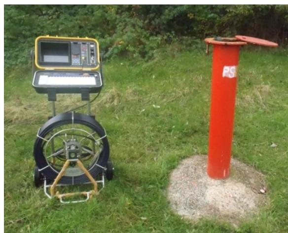
Obr. č. 6 Kamerový inšpekčný systém s tlačným perom vCam Digital/View
