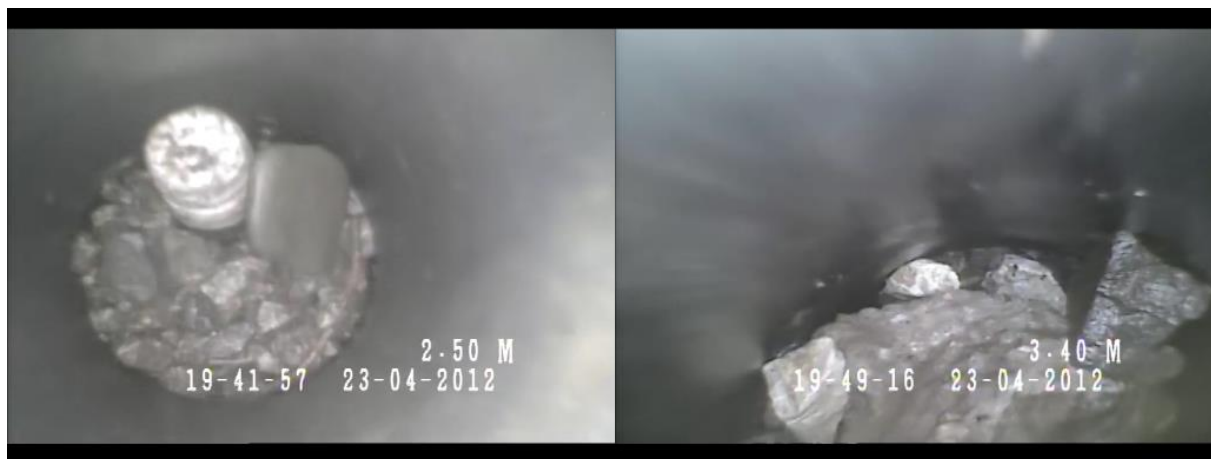
Obr. č. 2 Zmenšenie snímacej časti sondy cudzím predmetom - sonda PS 5H (vľavo) a PS 6A (vpravo)
