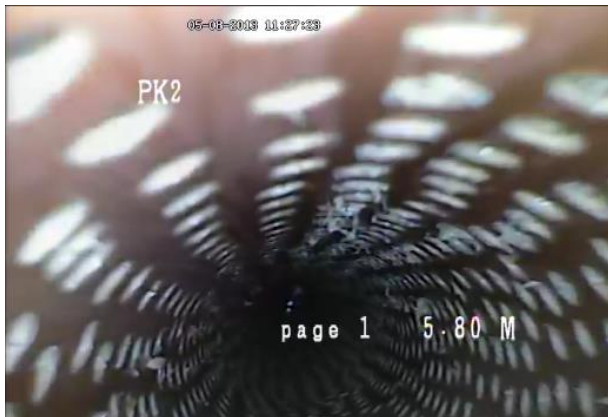
Obr. č. 8 Perforácia sondy PK 2 (5.8.2013)
