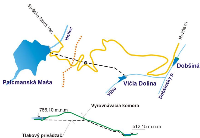
Obr. 1. Prehľadná schéma sústavy vodných stavieb Palcanská Maša – Vlčia Dolina – Dobšiná
